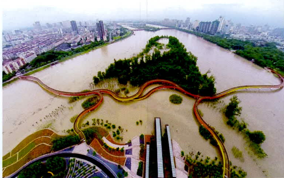
Hệ thống giao thông được chia thành nhiều cấp với cao độ khác nhau tương ứng với các ngưỡng cao nhất của nước lũ trong vòng 200 năm, 50 năm, 20 năm, 10 năm và từng năm
