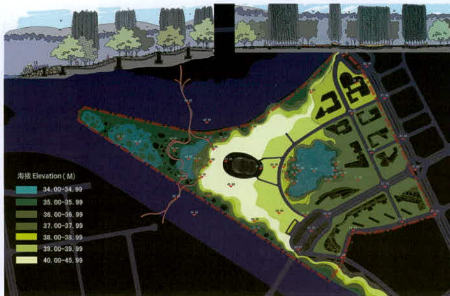
Phương án thiết kế tổng thể công viên cải tạo bờ sông thành hệ thống vành đai ruộng bậc thang nhiều cấp, tăng độ rộng vừa giảm tốc độ dòng chảy, qua đó làm giảm áp lực ngập úng cho TP
