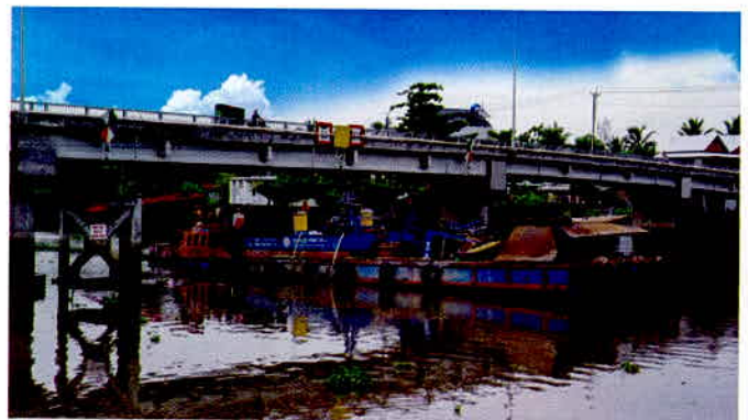
Trạm trộn bê tông di chuyển qua cầu thấp.
