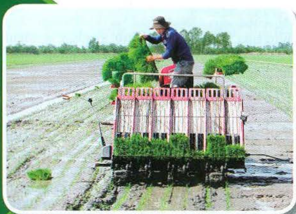
Ứng dụng máy cấy trong khâu xuống giống tại HTX Hiếu Bình
