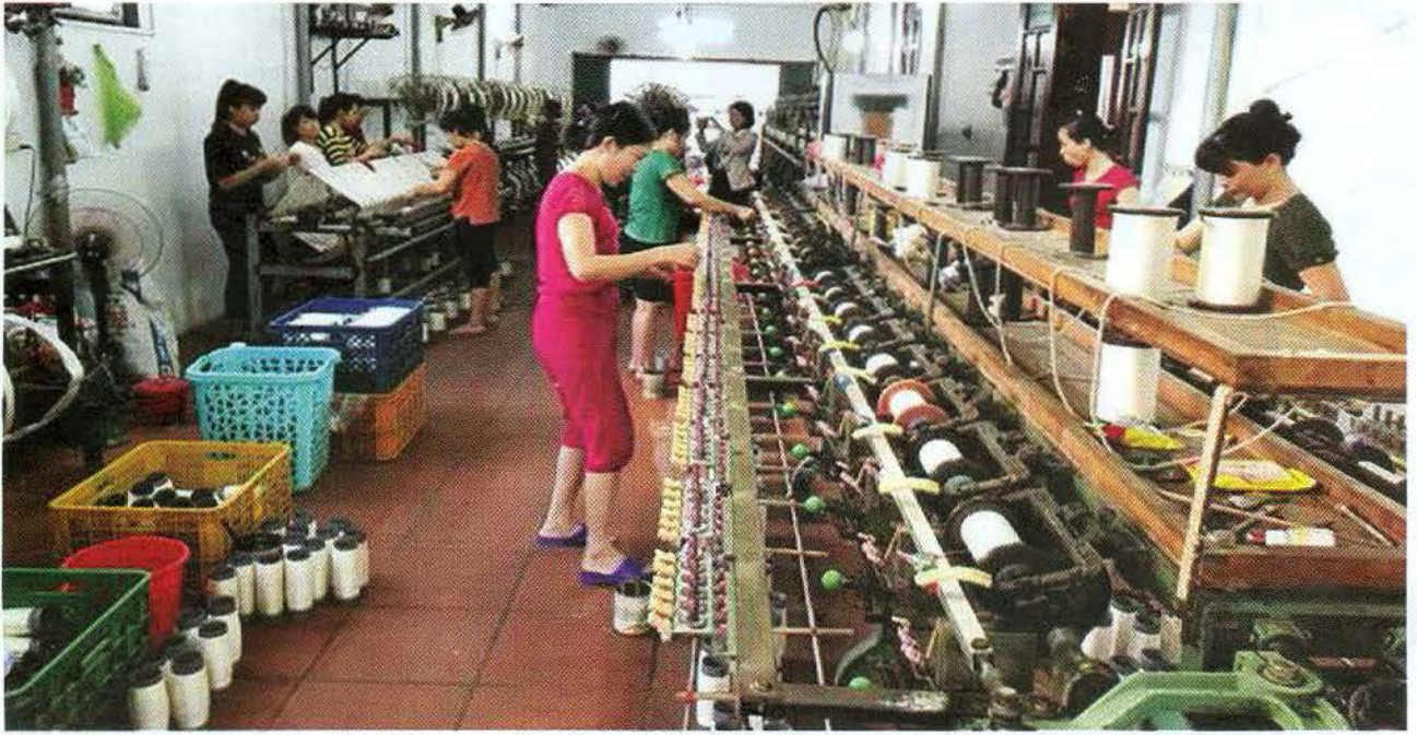
Bên cạnh việc xe tơ theo phương pháp thủ công truyền thống, ngày nay ở Cổ Chất xuất hiện rất nhiều gia đình mạnh dạn đầu tư máy móc hiện đại để thực hiện việc này nhằm đạt năng suất lao động cao.
