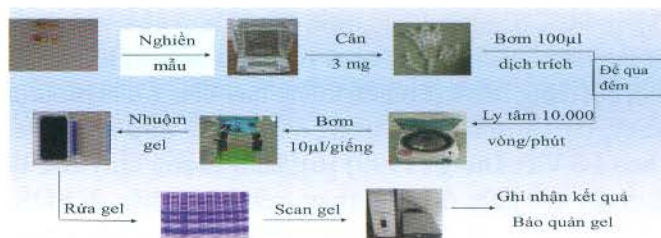
Hình 1: quy trình điện di protein tổng số theo phương pháp SDS-PAGE
